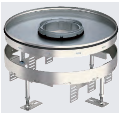
Nivellierbare Kassette der Nenngröße R9 für Tubus für den Einbau von Installationsgeräten in trocken oder nass gepflegten Fußböden.
